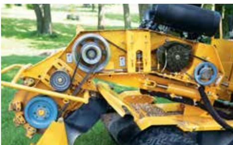
**FACILE MANUTENZIONE DELLE CINGHIE.** È possibile effettuare gli interventi di manutenzione alle cinghie della SC292 da un lato della macchina, mentre le cinghie della trasmissione del dispositivo di taglio sono regolabili mediante ingranaggi folli mobili. Inoltre, le impostazioni delle cinghie possono essere regolate indipendentemente l'una dall'altra, senza il bisogno di dover intervenire sulle altre cinghie.
