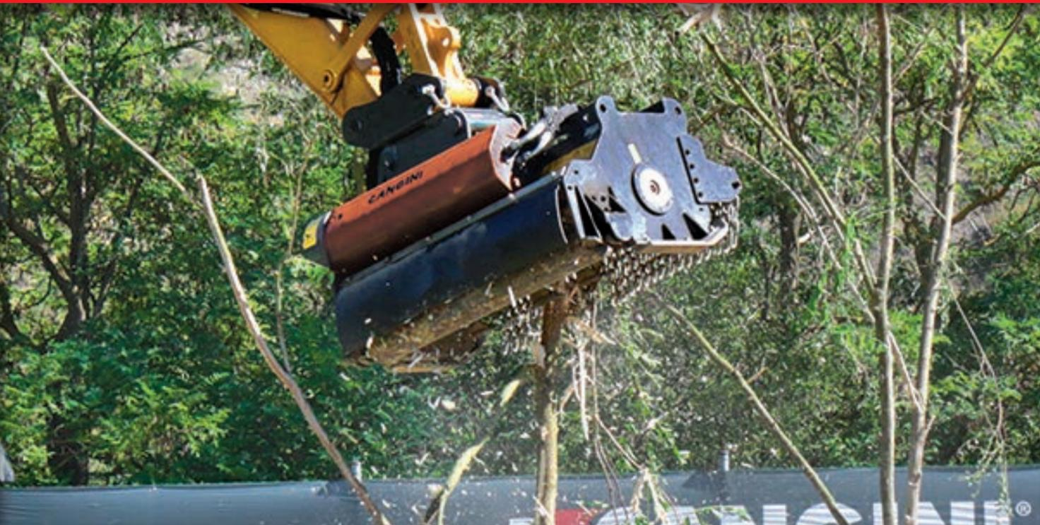
LA TESTATA TRINCIANTE È PROGETTATA PER UN UTILIZZO PARTICOLARMENTE GRAVOSO, È DOTATA DI SCOCCA RINFORZATA E CARTER DI PROTEZIONE CUSCINETTI. DI SERIE COLTELLI A Y CON INTERMEDIO O MAZZE; VALVOLE REGOLATRICI DI FLUSSO, LIMITATRICE DI PRESSIONE E PORTATA (PER MODELLI TC0-50 E TC0-70 SOLO VALVOLA LIMITATRICE DI PRESSIONE). L'IMPIANTO DI DRENAGGIO INTEGRATO NON NECESSITA DI LINEA DI DRENAGGIO A SERBATOIO FINO A CONTRO-PRESSIONI MASSIME DI 10 BAR.
