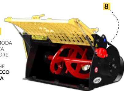
**KIT APERTURA MANUALE GRIGLIA DI PROTEZIONE:** CONFIGURAZIONE ESTREMAMENTE COMODA E SICURA. LA GRIGLIA VIENE INCERNIERATA SUPERIORMENTE, UNA MANIGLIA INFERIORE NE PERMETTE LO SGANCIO, L'APERTURA È ASSISTITA DA AMMORTIZZATORI A GAS CHE SOSTENGONO LA GRIGLIA. **UN INTERBLOCCO IDRAULICO BLOCCA LA ROTAZIONE DELLA COCLEA ALL'APERTURA DELLA GRIGLIA**
